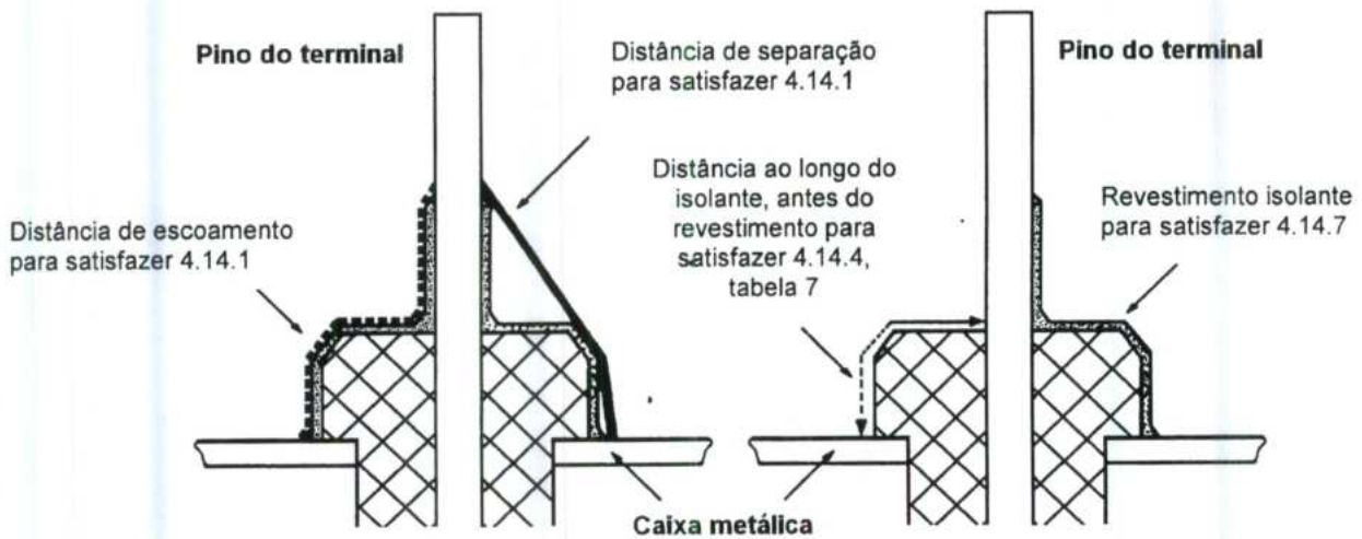
Figura F.12 — Exemplo de utilização de revestimento, para aumentar as distâncias de escoamento e de separação ao redor de um terminal
